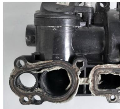
Abb. 5: Undichtigkeiten durch zusätzliche Dichtmittel (Schadensbild)
