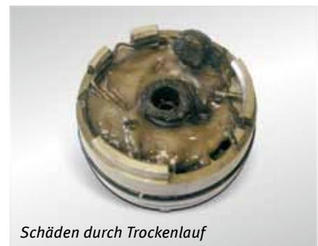
Wir empfehlen vor Kraftstoffpumpen vom Typ E1F einen grobmaschigen Siebfilter (Maschenweite 60...100 µm, z. B. PIERBURG Nr. 4.00030.80.0) einzusetzen. Er sollte im gleichen Wartungsintervall wie der Kraftstofffilter ausgetauscht werden.
