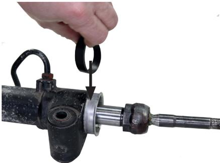
Je nach Bauart des Lenkgetriebes liegen Dichtringe bei. Sind diese in der Verpackung, müssen sie angebracht werden.
