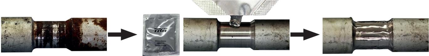
Vor dem Einbau des Faltenbalges müssen die Dichtflächen gereinigt und von Korrosion befreit werden. Zur Optimierung der Abdichtung ist auf die Spurstangendichtfläche das beigelegte Silikonfett aufzubringen. Immer die mitgelieferten, neuen Zubehörteile verwenden.
