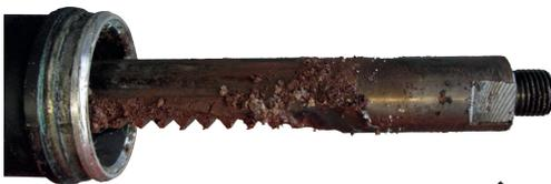
Bei Faltenbälgen keine normalen Schlauchschellen oder Kabelbinder verwenden. Der Faltenbalg kann dadurch Falten werfen. Durch diese können Wasser und Schmutz eindringen.
