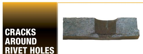
**CRACKS AROUND RIVET HOLES**
