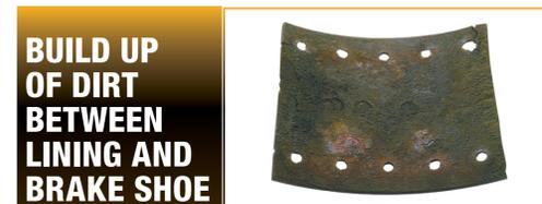
**BUILD UP OF DIRT BETWEEN LINING AND BRAKE SHOE**
