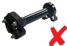
La transmisión está incompleta: falta una junta.
