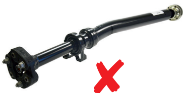
La transmisión está completa pero la barra está doblada.
