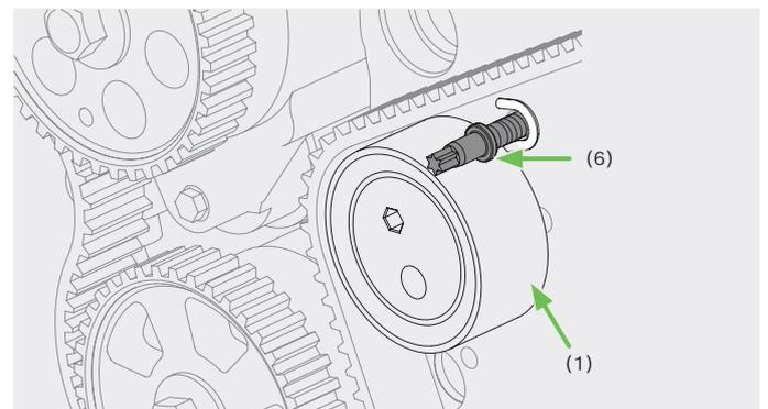
Spannrolle (1) mit der Schraube (5) M10 x 45 am Motorgehäuse montieren:
