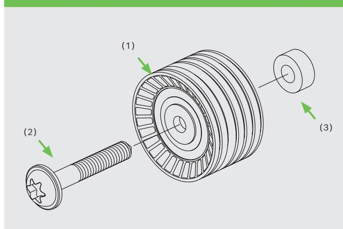
Die Umlenkrolle kann sich von der ausgebauten Umlenkrolle unterscheiden. Die neue Umlenkrolle wird mit der beiliegenden Schraube (2) M10 x 66 und der beiliegenden Buchse (3) montiert.
