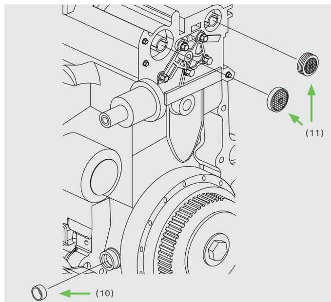
Bei der Montage des neuen Zahnriemenkits sind bei einigen Fahrzeugmodellen auch die Nockenwellenräder zu lösen. Diese Teile für die Nockenwellenräder liegen den Kits nicht bei, sie sind vom Fahrzeughersteller zu beziehen.
