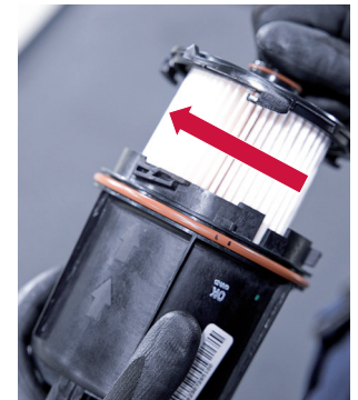
Abbildung 2: Die Variante mit brauner Dichtung hat einen Bajonettverschluss
