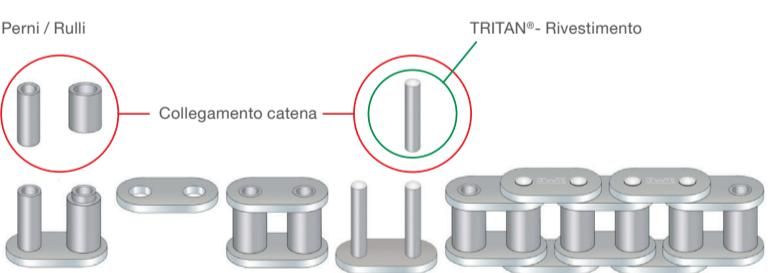
Le catene di distribuzione, progettate come catene a bussola o catene a rulli, consistono in una disposizione di collegamenti interni ed esterni. In questo caso, i perni e le boccole formano le superfici articolari.
