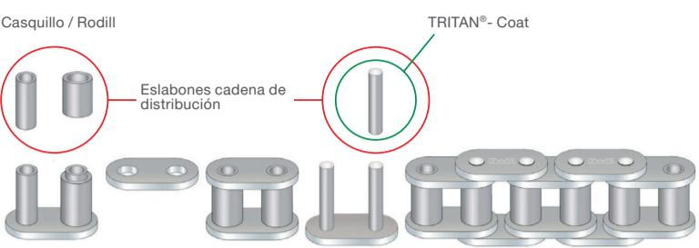
Las cadenas de distribución, diseñadas como cadenas de casquillos o cadenas de rodillos, consisten en una disposición de eslabones de cadena internos y externos. En este caso, los pasadores y los casquillos forman las superficies de las juntas.
