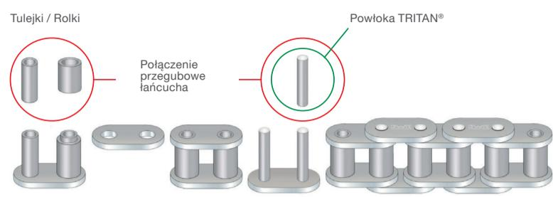
Różne wersje łańcuchów rozrządu – tulejkowe lub rolkowe – zbudowane są z połączonych ze sobą ogniw wewnętrznych i zewnętrznych. Sworznie i tulejki tworzą połączenia przegubowe.
