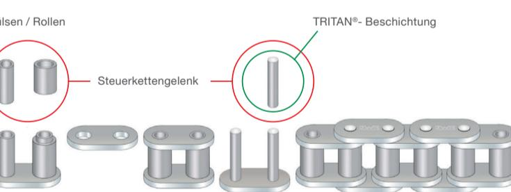
Steuerketten, ausgeführt als Hülsenketten oder Rollenketten, bestehen aus einer Anordnung von inneren und äußeren Kettengliedern. Die Gelenkflächen bilden dabei Bolzen und Hülsen.
