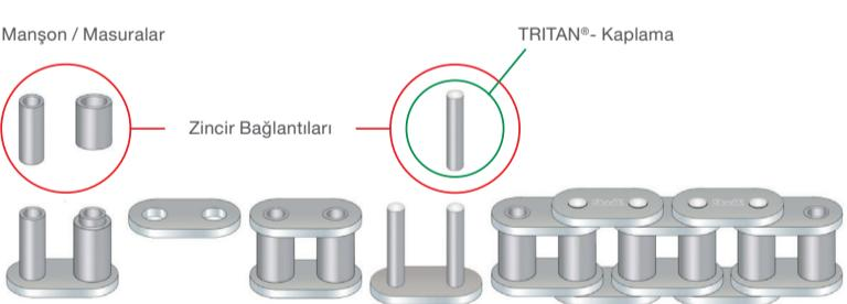
Burçlu veya makaralı olarak dizayn edilen eksantirk zincirler, iç ve dış bağlantı noktalarına sahiptir. Bu nedenle pimler ve masurlar üzerinde bir ek yüzey alanı oluşur. Yağ kalitesinin azalmasıyla beraber zincir üzerinde bir yprapma meydana gelir, yağ, karbon ve yakıt karışımı bağlantı noktalarında aşınmalara neden olur. Özellikle turboşarj direk enjeksiyonlu motorlarda zincirde bir esneme neden olur.
