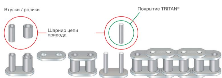
Цепи привода (втулочные и роликовые), состоят из внутренних и внешних звеньев. В качестве рабочих поверхностей шарнира используются сопряженные части валика и втулки.
